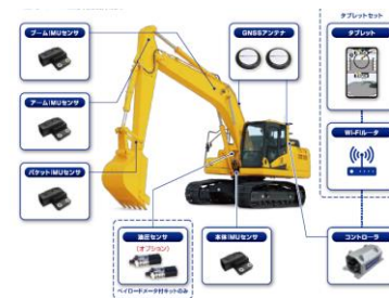
ICT化された建設機械イメージ
